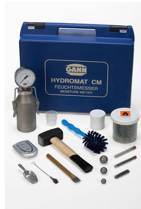
El equipo de medición Hydromat CM es un equipo que sirve para determinar, a través del método del carburo de calcio, la humedad contenida en los materiales de construcción ya fraguados.
